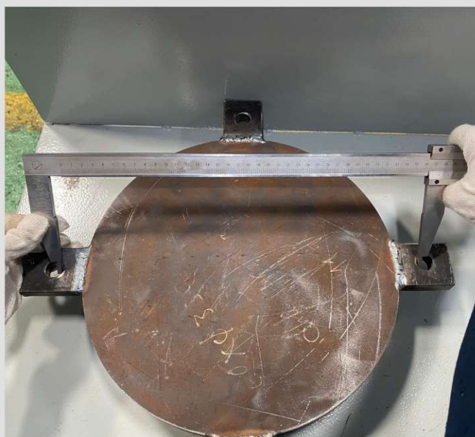
Kiểm tra kích thước tìm lỗ sau khi hàn tại neo
