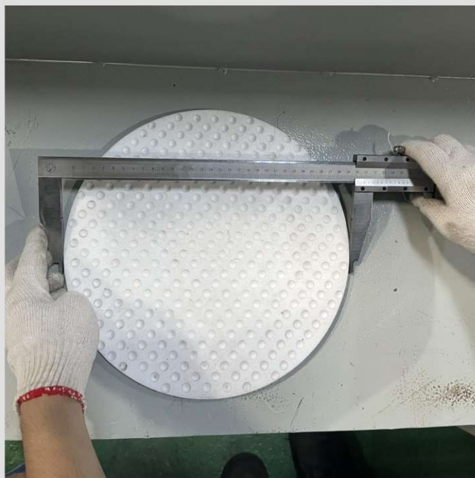
Kiểm tra tấm PTFE sau khi gia công
