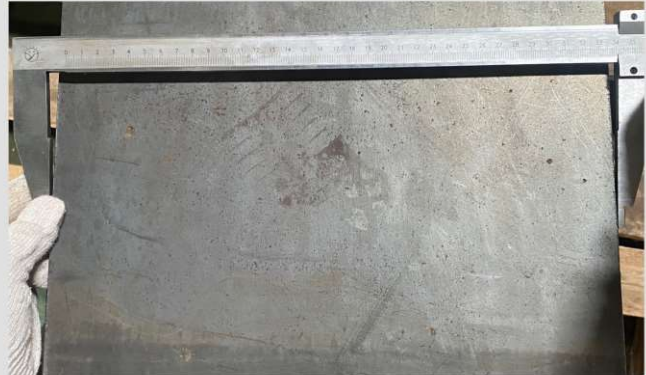
Kiểm tra kích thước thớt trên sau khi cắt
