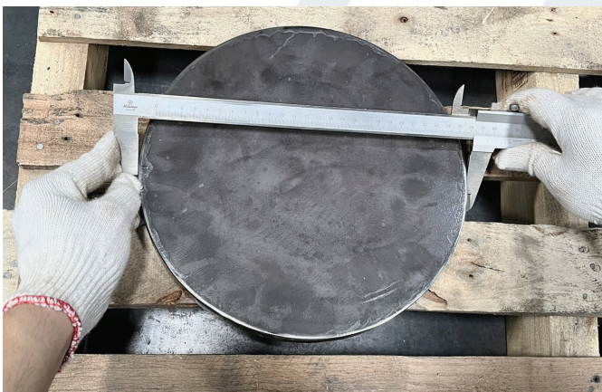
Kiểm tra kích thước piston sau khi cắt
