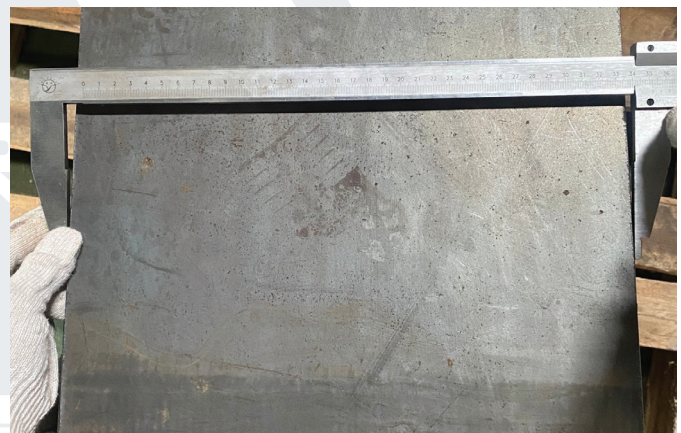
Kiểm tra kích thước thớt trên sau khi cắt
