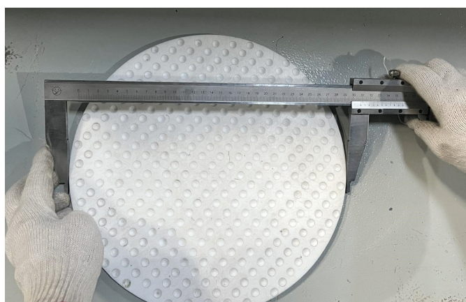
Kiểm tra tấm PTFE sau khi gia công
