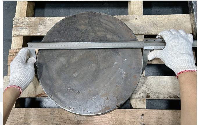
Kiểm tra kích thước chậu sau khi cắt
