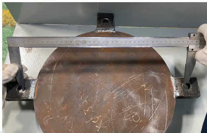
Kiểm tra kích thước tim lỗ sau khi hàn tai neo
